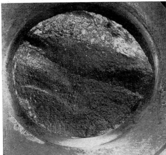
Fig. 13a — Ruptura praticamente transversal por torção cíclica após 250 h de trabalho, no eixo junto à concordância com o braço de uma árvore-de-manivelas de um motor Diesel.
