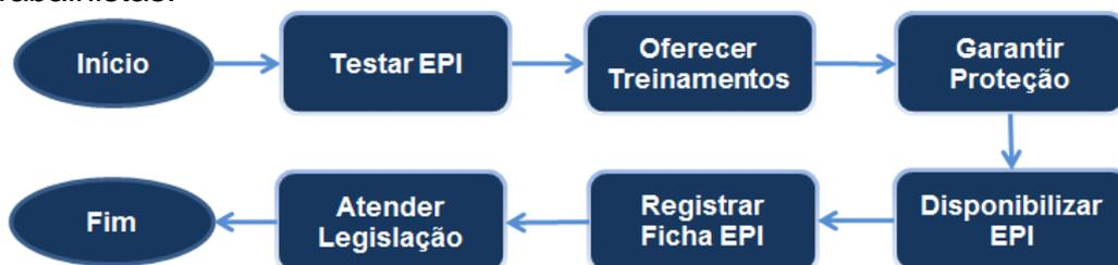
Figura 1. Fluxo de controle de EPI <sup>(9)</sup>
