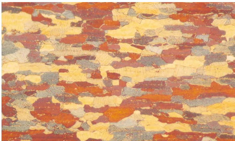
Figura 5. Microestrutura do material produzido com relação Al/N=17. (500X).
