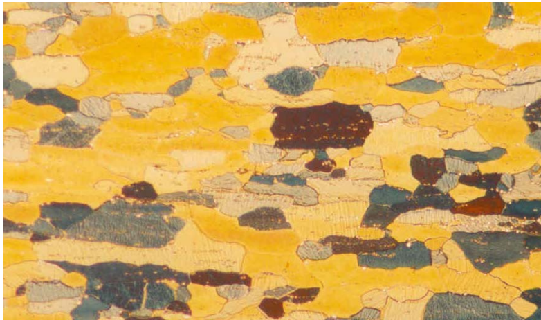
Figura 4. Microestrutura do material produzido com relação Al/N=11. (500X).
