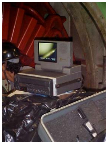
Figura 11. Endoscópio utilizado para inspecionar as saídas de ranhura e o rotor.
