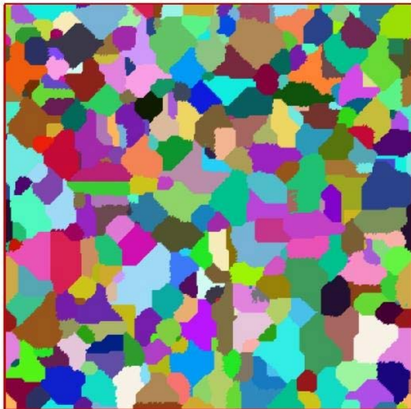
Figura 7. Microestrutura gerada pelo método do autômato celular quando se atinge 100% de fração recristalizada.
