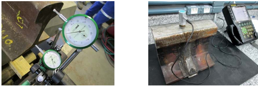
Figura 5. (a) Posicionamento dos relógios comparadores na determinação da expansão linear (dilatação) dos trilhos durante o procedimento de soldagem aluminotérmica. (b) Medição da atenuação ultrassônica a \frac{1}{4} da solda aluminotérmica.
