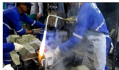
Término do pré-aquecimento, ainda com desprendimento de gases 07m:09s
