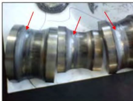
Figura 7 – Desgaste prematuro dos roletes.
