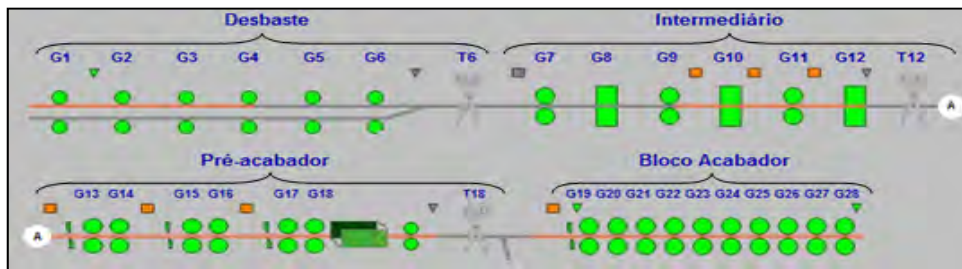
Figura 2 – Esquema do laminador Morgan
