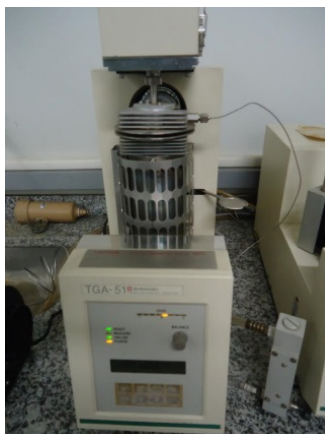
Figura 1: Analisador Térmico SHIMADZU Modelo TGA 51
