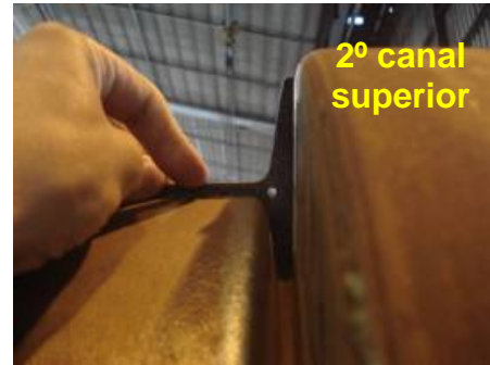
Figura 2 – Dados dimensionais para largura (Aba 2) para perfil I 4" x 2 alma.
