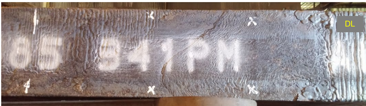
Figura 9. Alarame de canto induzido pela transmissão de um colamento da face larga (tipo B).
