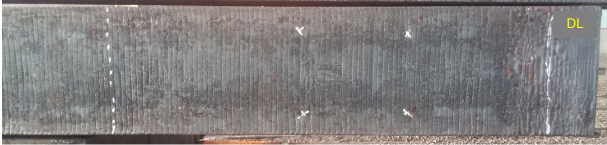
Figura 7. Alarame de canto falso, marcas de oscilação paralelas abaixo do duplo lingotamento.
