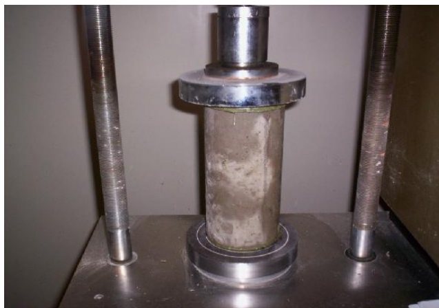
Figura 3 – Rompimento dos corpos de prova.
