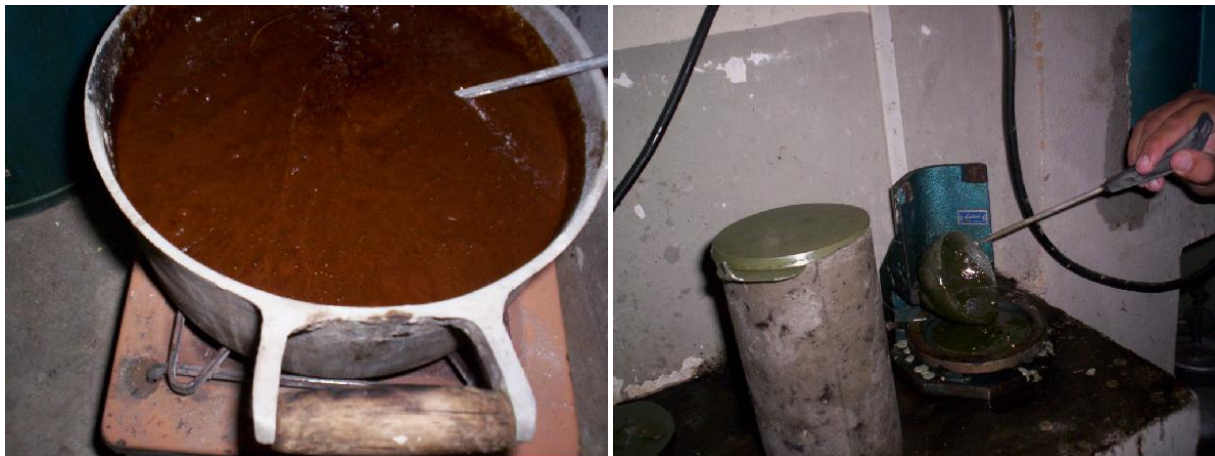
Figura 2 – Capeamento dos corpos de prova.
