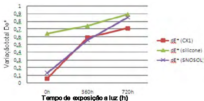
Figura 1 – Variação total de De* ( Delta E) em gabinetes em função das horas de exposição a luz de chapas extrudadas em HIPS tratadas com silicone acético e solvente isoparafínico. CX1- caixa isenta de agentes químicos; silicone - caixa com silicone a base de ác. acético na região de vedação; SNOSOL- caixa com produto de limpeza a base de hidrocarboneto isoparafínico em toda sua extensão.
