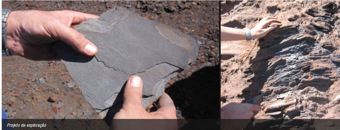
Figura 4. Esquerda: minério Itabirito com uma coloração escura (esquerda). Direita: estrutura bandada ou estratificada do itabirito [8].
