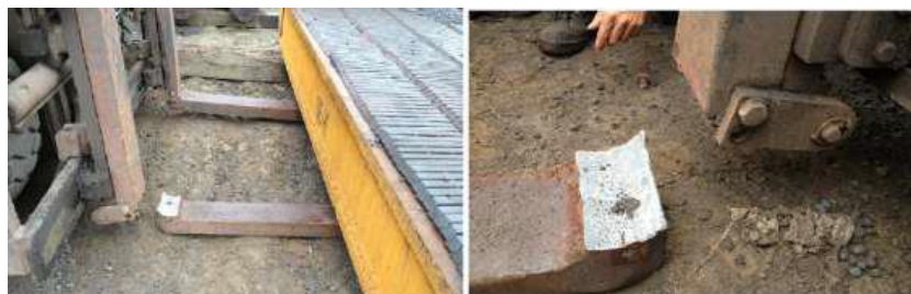
Figura 2. Garfos fraturados em campo. [1]
