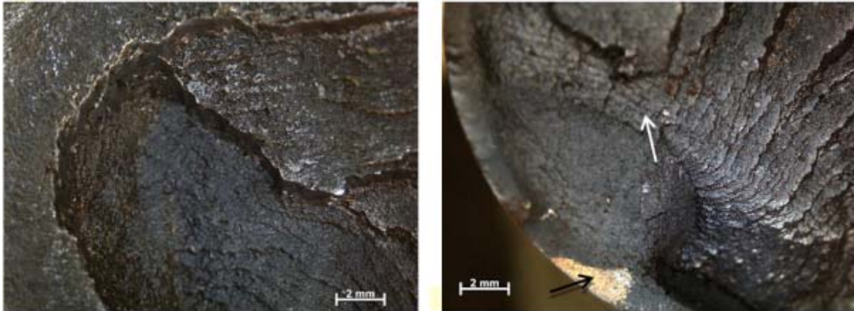
Figura 3. Aspecto da fratura do pino (1) e do pino (2) respectivamente, vistos em microscópio estereoscópico. A seta preta indica uma camada superficial lisa que indica uma fratura frágil devido a algum tratamento térmico superficial. A seta branca indica linhas concêntricas (marcas de praia) que estão relacionadas à propagação instável da trinca.
