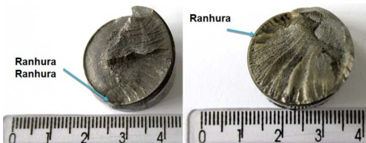
Figura 2. Superfície de fratura do pino -1 e pino-2, respectivamente.
