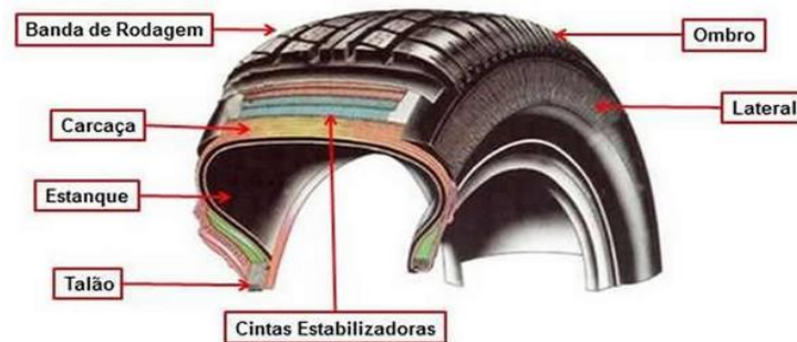
Figura 2. Partes de um pneu.
