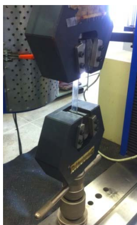
Figura 3: Ensaio de resistência à tração (Fonte: arquivo pessoal)
