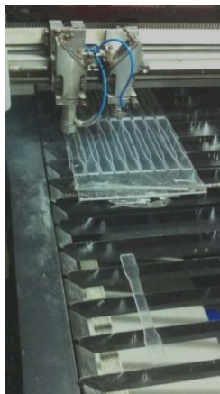
Figura 2: Corte a laser dos corpos-de-prova
