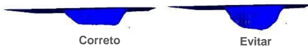
Figura 42 – Formato da vala
