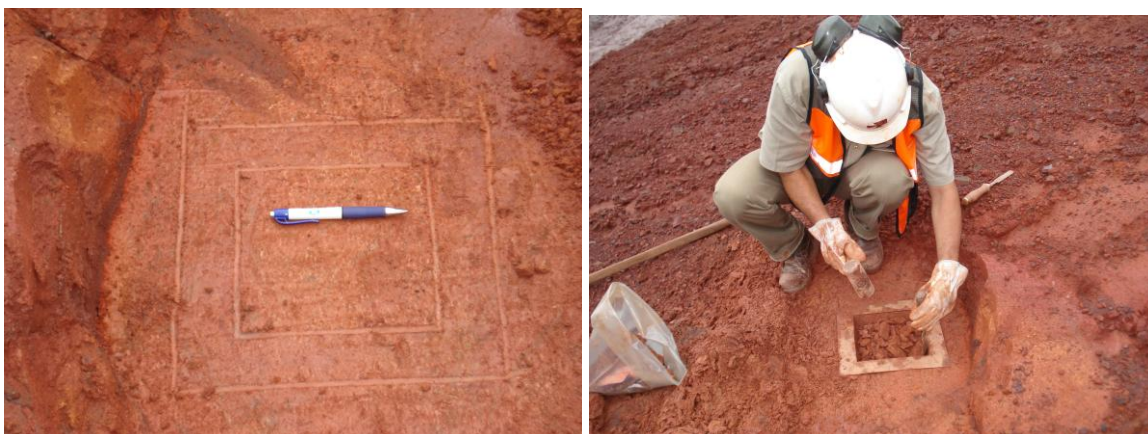
Figura 30 – Cavando o poço
