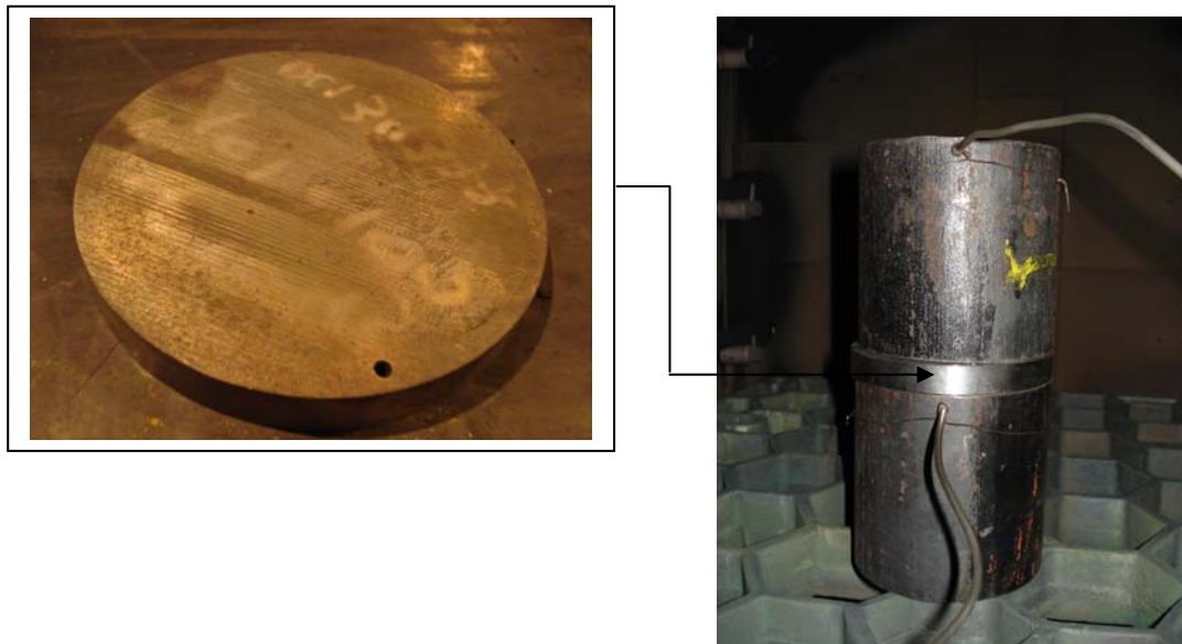
Figura 6. Detalhe do corpo de prova e montagem do conjunto com termopares na superfície e núcleo.
