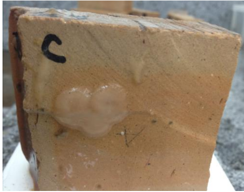
Figura 2. Efeito visível antes da peça A3 ser submersa em água fervente.
