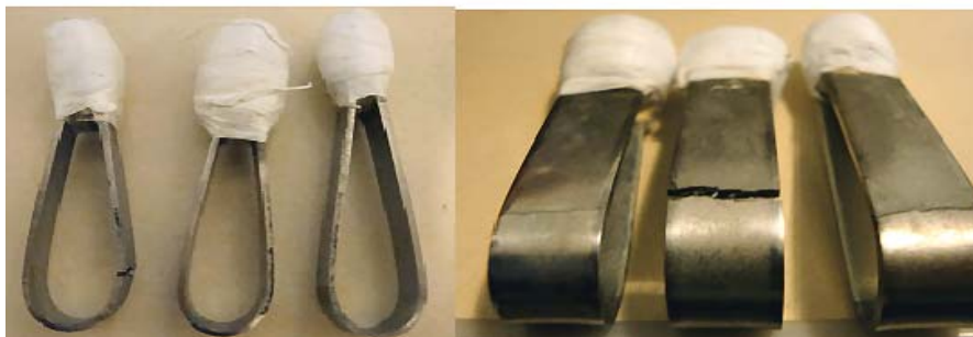
Figura 8 - Fratura por corrosão sob tensão em CPs em U; aço UNS S32304, deformação constante; 42% (massa) MgCl_2 ( 143^\circ C ).
