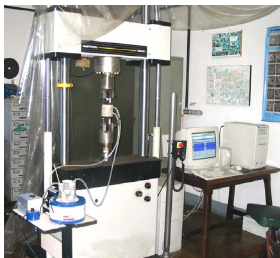
Figura 3: Máquina servo-hidráulica Instron, 25t; sistema para ensaios de corrosão-fadiga.
