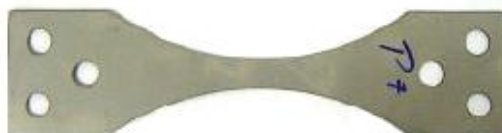
Figura 2: Amostra de corpo-de-prova para ensaios de corrosão-fadiga. Comprimento = 200 mm; largura = 12,7 mm.
