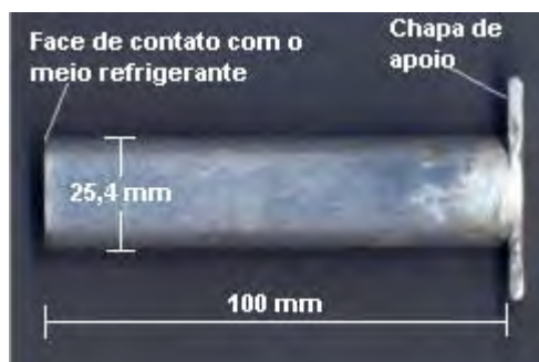
Figura 2: Corpo de prova pronto para o ensaio.
