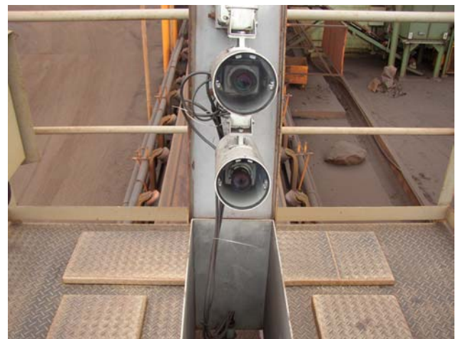
Figura 5. Caixa de proteção da câmera e conjunto Câmera/lente utilizado
