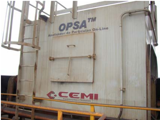
Figuras 3 e 4. Montagem da caixa e a caixa da câmera sobre a correia transportadora.
