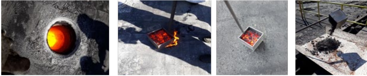
Figura 2. Dispositivo para coleta de amostras de depósito de carbono nas regiões da boca de carregamento e tubo de ascensão.
