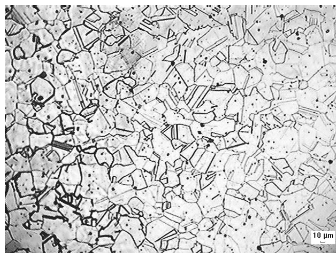
Figura 3. Micrografia do Inconel 718 sem tratamento de duplo envelhecimento.
