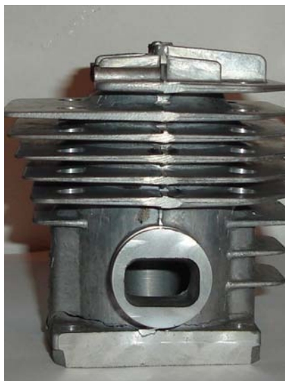
Figura 1: Cilindro produzido por fundição sob pressão em liga de magnésio.
