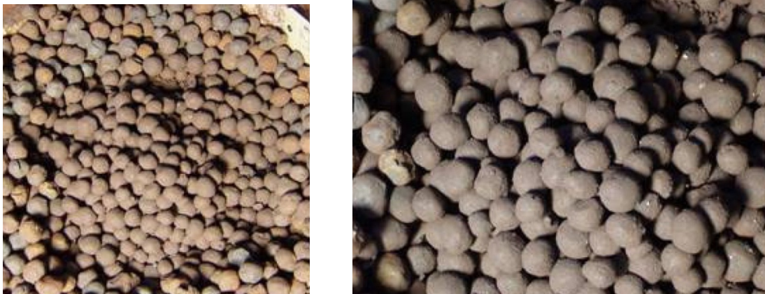
Figura 8. Pelotas calcinadas produzidas com adição de lama de alto-forno.
