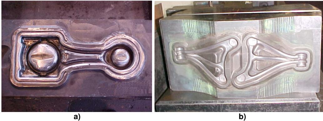
**Figura 5:** a) Matriz para forjamento a quente de biela, analisada no caso 2, em que o aço VHSUPER foi testado. b) matriz de forjamento de suporte de motor, em que testou-se o TENAX 300.
