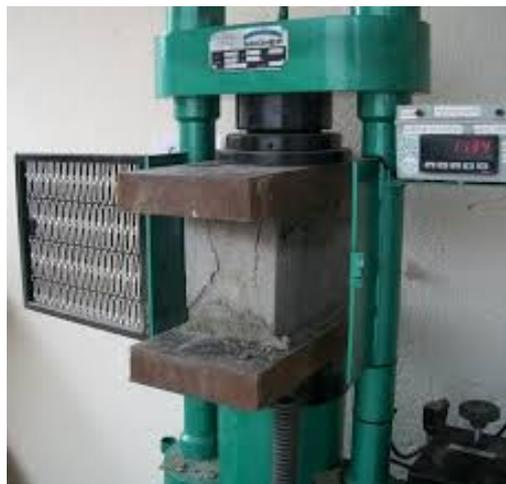
**Figura 4.** Execução do ensaio de resistência mecânica dos blocos de concreto.
