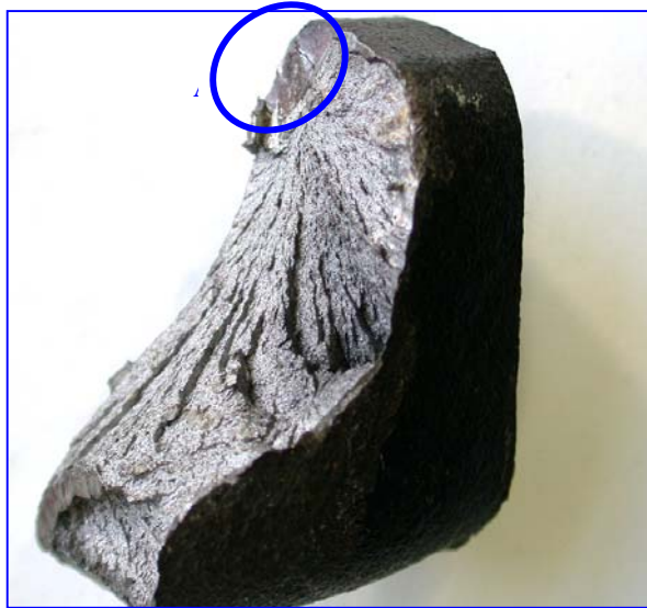
Figura 4. Aspecto macrográfico da superfície de fratura, posição oblíqua.
