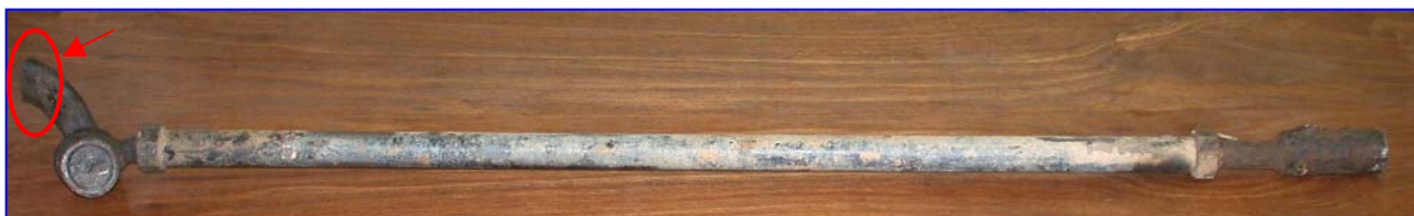
Figura 1. Barra de direção fraturada; o círculo vermelho indica o local da fratura.
