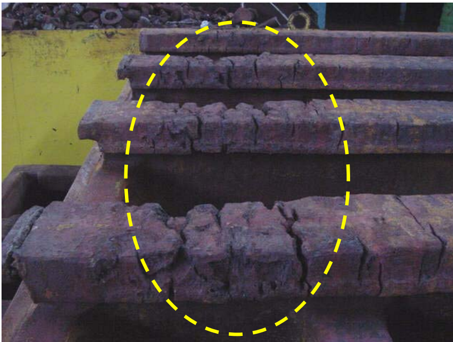
Figura 6 - (a) Empenamento devido a gradientes térmicos na estrutura fortemente vinculada, e (b) "Queima" localizada do carro devido ao fluxo preferencial de gases próximo à sua lateral.
