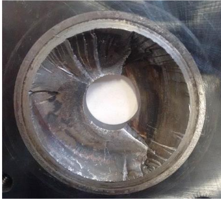
Figura 2. Superfície de fratura por fadiga devido a carga de flexão rotativa, apresentando marcas radiais de catraca indicativas de nucleação da fadiga ao longo de todo o perímetro do raio de curvatura. Marcas de praia indicam a superfície lida de propagação. Em (a), vista onde a seta indica o local por onde passou o plano radial de corte metalográfico. Em (b), vista de topo.
