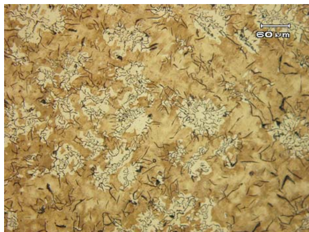
Figura 6: Imagem mostrando ferrita nas regiões de veios de grafita tipo ASTM B. Aumento: 200x.
