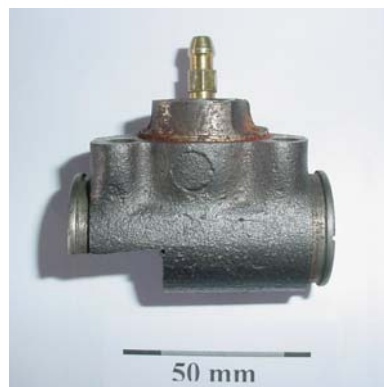
Figura 2: Cilindro de roda conforme recebido para análise.
