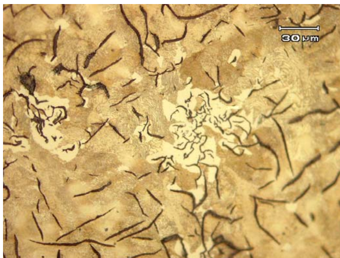
Figura 7: Imagem mostrando, em maior aumento, as regiões de ferrita. Aumento: 500x.
