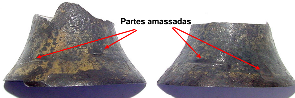
Figura 4: Zona de concordância entre a cabeça e o corpo da haste de bombeio apresentando regiões amassadas.
