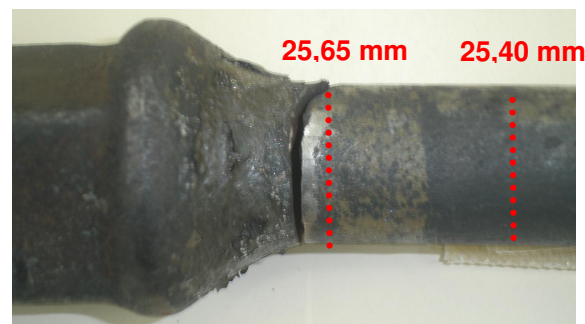
Figura 3: Detalhe da diferença de diâmetro entre a região da fratura e a haste.
