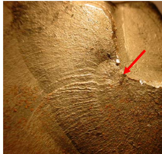
Figura 4: Imagem mostrando, em maior aumento, a região de início da falha. A seta em vermelho indica o ponto de início da fratura.
