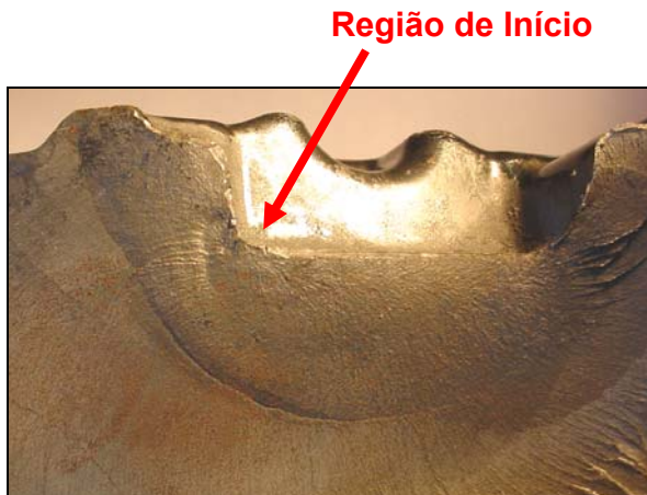
Figura 3: Imagem mostrando a superfície de fratura da matriz recebida para análise de falha. Em detalhe a região de início da falha.
