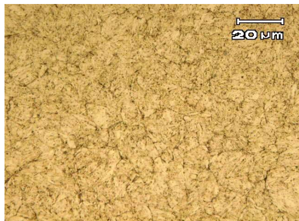
Figura 12: Micrografia da região do núcleo da amostra.
