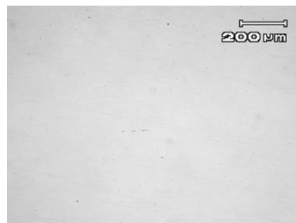
Figura 9 - Micrografia da bandeja tibial mostrando inclusões de sulfeto de manganês do tipo A ½ fina.
