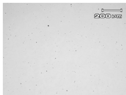
Figura 7 - Micrografia do componente femoral mostrando as inclusões de óxidos do tipo D 2 ½ fina.
