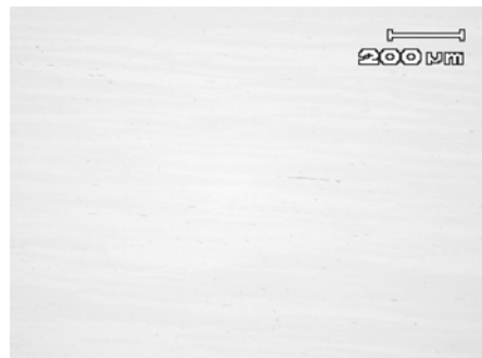
Figura 15 - Micrografia do parafuso mostrando inclusões de sulfeto de manganês tipo A 1 fina.
