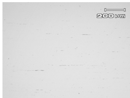
Figura 11 - Micrografia da haste extensora mostrando inclusões de sulfeto de manganês tipo A 2 ½ fina.
