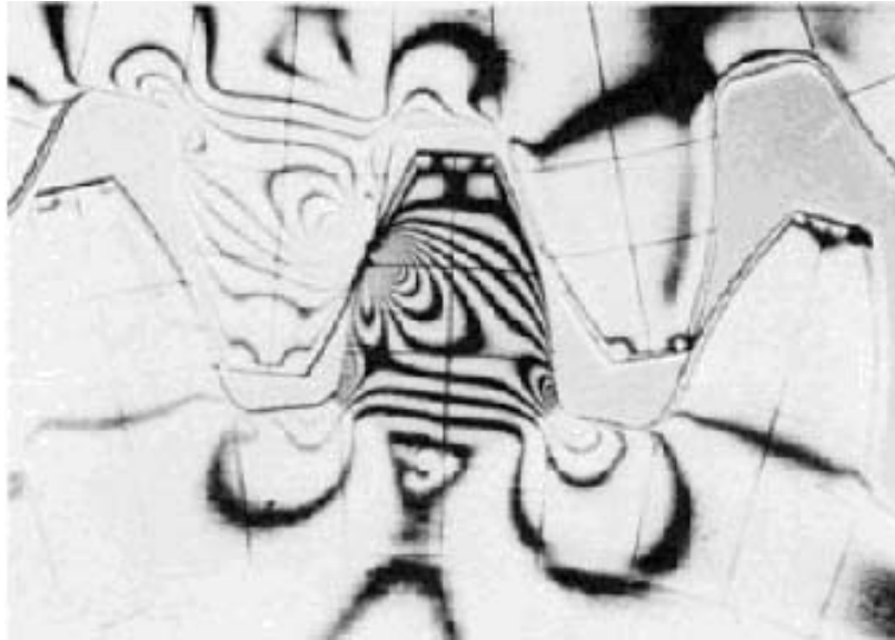
Figura 5: Estudo fotoelástico de dois dentes de engrenagens recebendo carregamento. [2]
