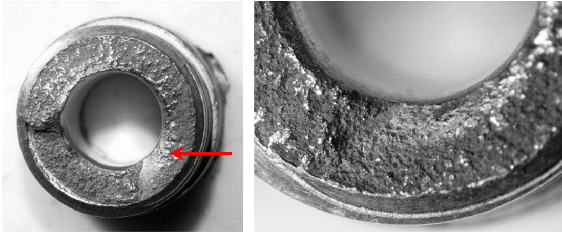
Figura 5: Imagem em lupa de baixo aumento da superfície de fratura. A seta indica a região analisada em MEV e mostrada na Figura 7. À direita, em maior aumento.
