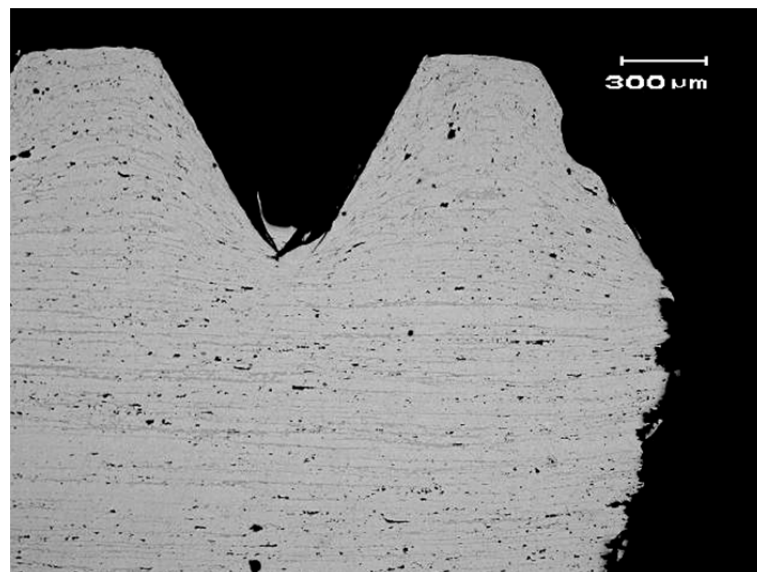
Figura 12: Micrografia da secção transversal mostrando a superfície fraturada (à direita) e a rosca. Sem ataque.
