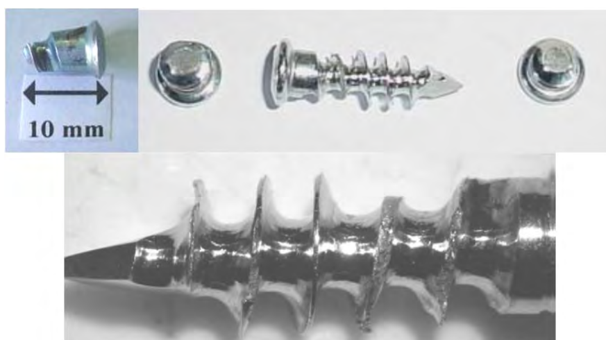
Figura 3. A imagem acima a esquerda mostra o parafuso do caso 1 rompido. A fratura ocorreu na região do primeiro filete. A imagem acima a direita mostra os parafusos do caso 2: a seção transversal dos dois parafusos rompidos e o parafuso remanescente de 24 mm de comprimento. A imagem abaixo mostra rupturas em cristas de filetes do parafuso remanescente. Ranhuras longitudinais também podem ser vistas.
