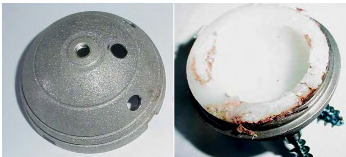
Figura 2. Imagens mostrando a esquerda a superfície porosa do componente acetabular do caso 2, e a direita a concavidade do liner do caso 1. Ambos componentes apresentam diâmetro externo de 50 mm.
