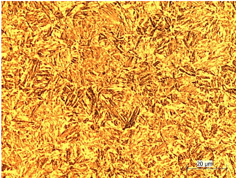
Figura 5. Microestrutura predominantemente martensítica do parafuso 1.
