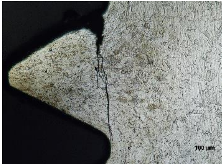
Figura 7. Trincas secundárias ramificadas de corrosão sob tensão iniciando na raiz de filete do parafuso 1. Microestrutura de grãos refinados de austenita, maclas de recozimento e linhas de fluxo de laminação de filetes.
