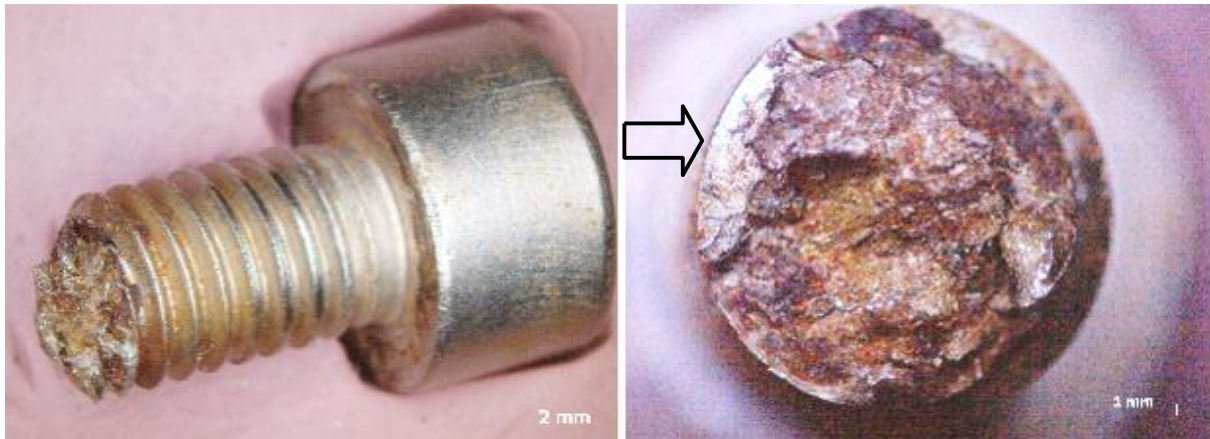
Figura 2. Parafuso 2. Superfície rugosa de fratura (esquerda) e produtos de corrosão sobre a fratura rugosa (direita). A seta indica região de início da fratura, diametralmente oposta à região de cisalhamento final.
