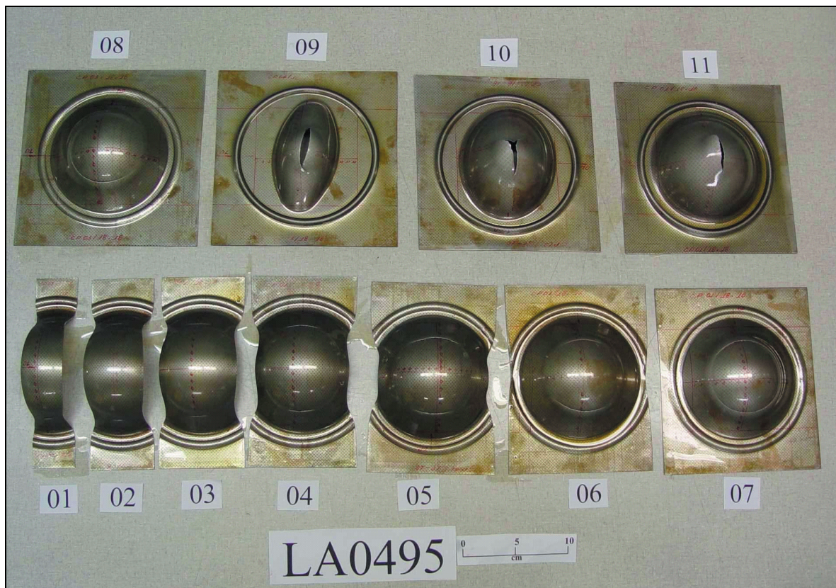
Figura 3. Foto dos blanks para ensaio Nakazima e Bulge-Test, depois de ensaiados.
