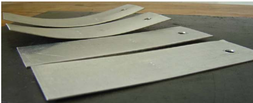
Figura 10 - Comparação entre as chapas mais distorcidas de cada condição de resfriamento (vista lateral). De cima para baixo respectivamente: água fria, água quente, solução aquosa de polímero a 12% e solução aquosa de polímero a 20%, agitação média, liga AA2024.
