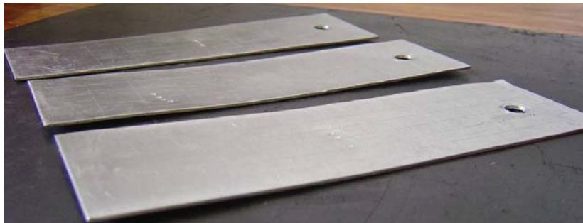
Figura 9 - Meio de têmpera solução aquosa de polímero com concentração de 20% a 40°C, agitação média, liga AA2024 (vista lateral).
