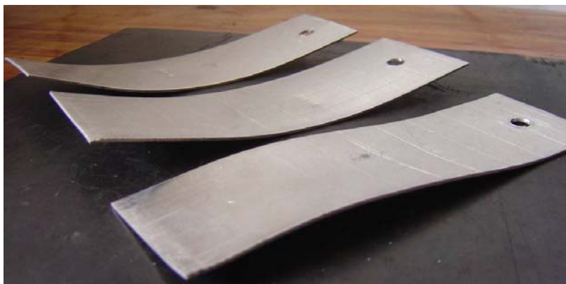
Figura 7 - Meio de têmpera água quente a 70°C, agitação média, liga AA2024 (vista lateral).
