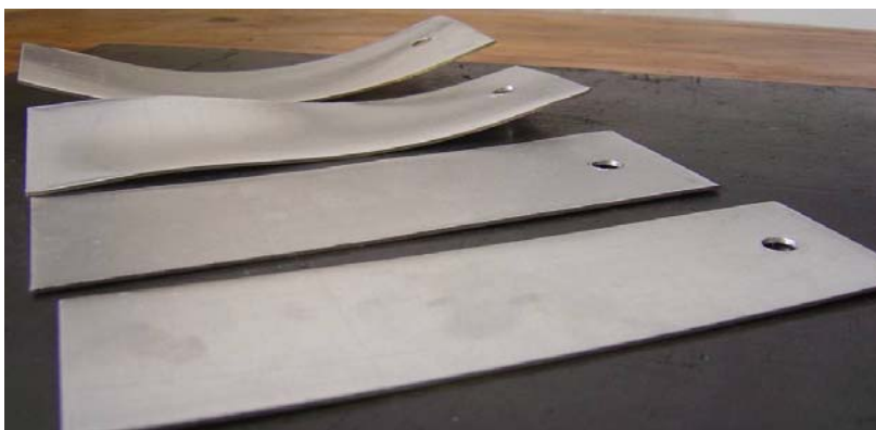
Figura 11 - Comparação entre as chapas mais distorcidas de cada condição de resfriamento (vista lateral). De cima para baixo respectivamente: água fria, água quente, solução aquosa de polímero a 12% e solução aquosa de polímero a 20%, agitação média, liga AA7475.
