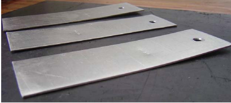
Figura 8 - Meio de têmpera solução aquosa de polímero com concentração de 12% a 40°C, agitação média, liga AA2024 (vista lateral).
