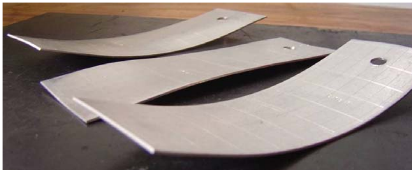
Figura 6 - Meio de têmpera água fria a 30°C, agitação média, liga AA2024 (vista lateral).
