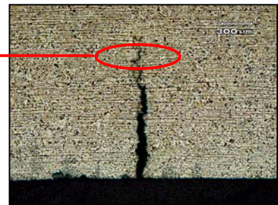
Figura 9. Micrografia mostrando liga de cobre nos contornos dos grãos e também dentro da trinca.
