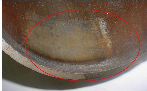
Figura 2. Imagem mostrando a região onde foi realizado o ensaio de ultra-som em uma das curvas.
