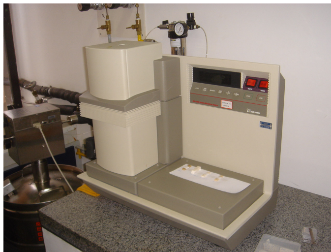
Figura 3. Equipamento da TA Instruments utilizado nos ensaios de DMA.
