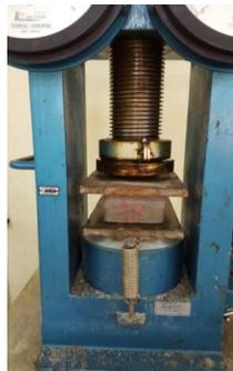
Figura 3. Bloco na prensa
