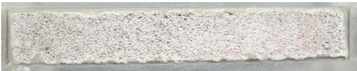
Figura 3. Elemento poroso de dimensões (20x150x20)mm usado no plugue.
