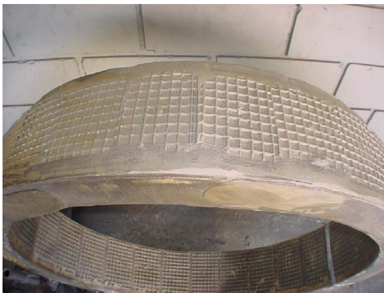
Figura 2. Peça Bruta, após desmoldagem e rebarbação antes das melhorias.
