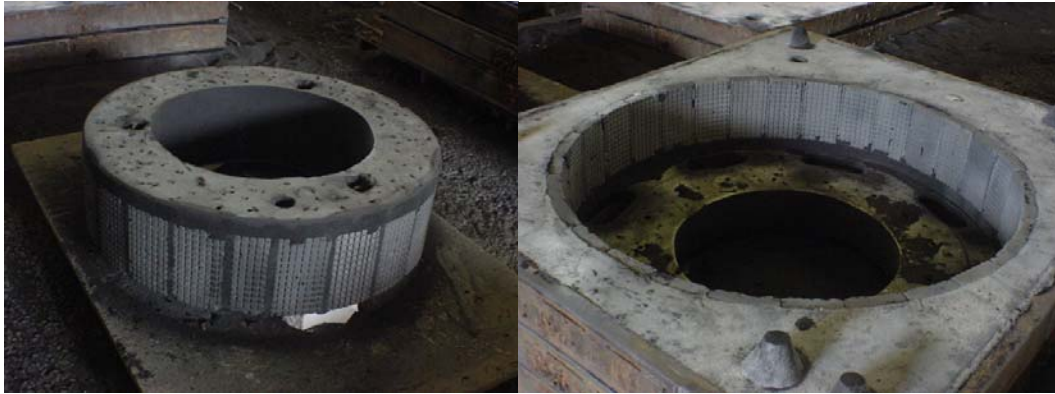
Figura 1. Macho e Molde para os diâmetros interno e externo da peça.
