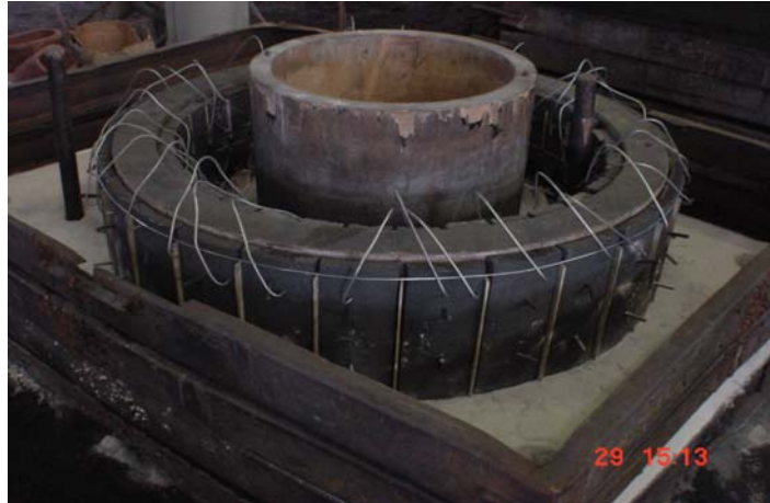
Figura 4. Visualização de separadores, grampos de fixação e montagem.
