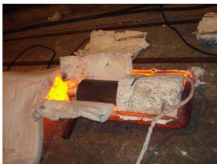
Figura 4. Foto da barreira térmica no momento de desenformamento.
